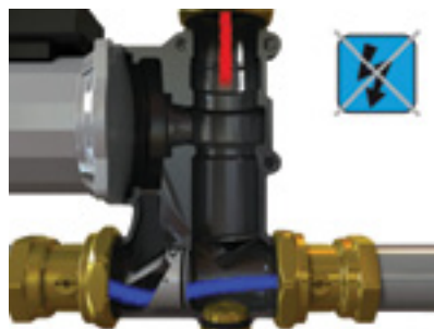
Funkce „plnicí jednotky“ s trojcestným ventilem pokud nejde elektrina a oběhové čerpadlo nepracuje (zpětná klapka je otevřena a ventil propouští samotížně)
